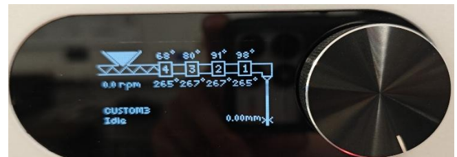
Figure 37 Températures extrusion PLA
